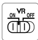
Выберите ON (ВКЛ.) чтобы включить подавление вибраций. Подавление вибраций включается, когда спусковая кнопка затвора нажата наполовину, уменьшает эффект дрожания фотокамеры, что улучшает кадрирование и фокусировку.
