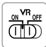
**Vyberte ON na aktiváciu stabilizácie obrazu.** Ak je tlačidlo spúšte stlačené do polovice, aktivuje sa stabilizácia obrazu, čím sa redukujú účinky chvenia fotoaparátu a zlepšuje sa zaostrovanie.
