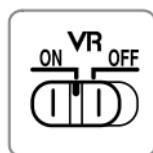
**Sélectionnez ON (ACTIVÉ) pour activer la réduction de vibration.** La réduction de vibration est activée lorsque vous appuyez à mi-course sur le déclencheur, réduisant ainsi les effets du bougé d'appareil pour vous permettre d'améliorer le cadrage et la mise au point.
