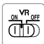
选择 **ON** 启用减震。减震将在您半按快门释放按钮时激活，从而减少照相机震动的影响以改善构图和对焦。
