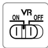
**Wählen Sie ON (EIN), um den Bildstabilisator zu aktivieren.** Der Bildstabilisator wird aktiviert, wenn der Auslöser bis zum ersten Druckpunkt gedrückt wird; er verringert die Effekte einer Kamera-Verwacklung für verbesserte Motivwahl und Scharfstellung.
