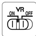
**Selezione ON para ativar a redução de vibração.** A redução de vibração é ativada quando o botão de disparo do obturador é pressionado ligeiramente, reduzindo os efeitos de tremor da câmera, para melhorar o enquadramento e a focagem.
