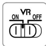
**Seleccionar ON para activar a redução de vibração.** A redução de vibração é activada quando o botão de disparo do obturador é premido ligeiramente, reduzindo os efeitos do tremor da câmara para melhorar o enquadramento e a focagem.
